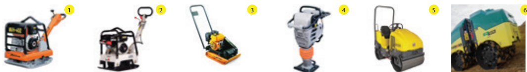
1 - PLACA REVERSÍVEL PESADA 2 - PLACA COMPACTAÇÃO REVERSÍVEL 3 - PLACA COMPACTAÇÃO À FRENTE 4 - COMPACTADOR DE PERCUSSÃO 5 - ROLO WACKER NEUSON RD12 6 - ROLO CONTROLE REMOTO AMMANN
